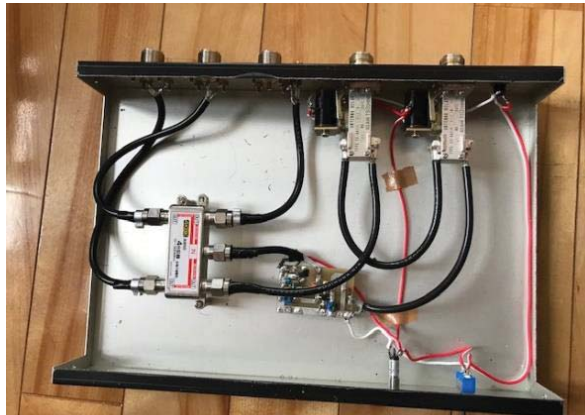
アンテナ分配器(内部)
