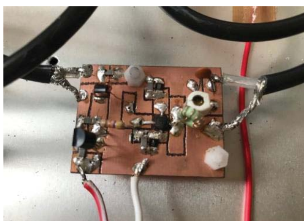
144MHz プリアンプ(GaAs ガリヒ素 FET 使用)
